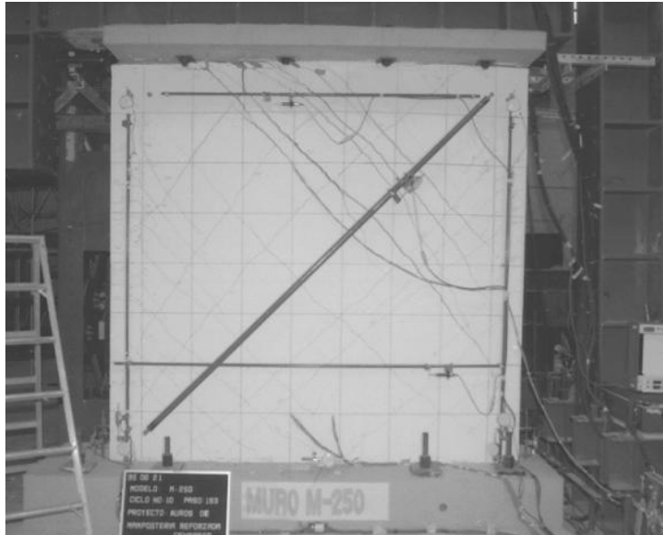
Figura 3.17 Modelo M-250: estado final del daño, luego de ocurrir la falla por cortante de entrecara entre la losa y el muro
