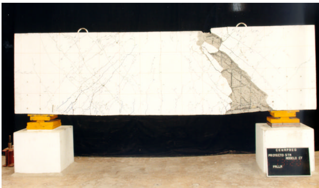
Figura 6.5 – Condición final de daño (modelo CT)
