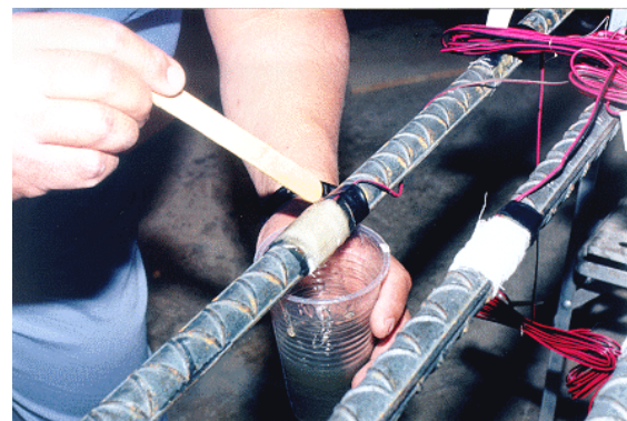
d) protección con resina
