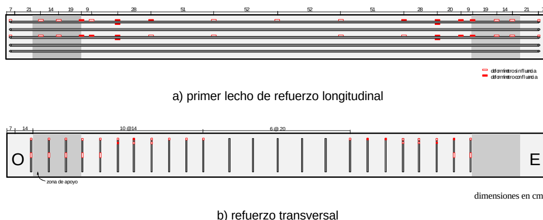
Figura 7.22 – Fluencias en el refuerzo –vista en planta– (modelo CR)
