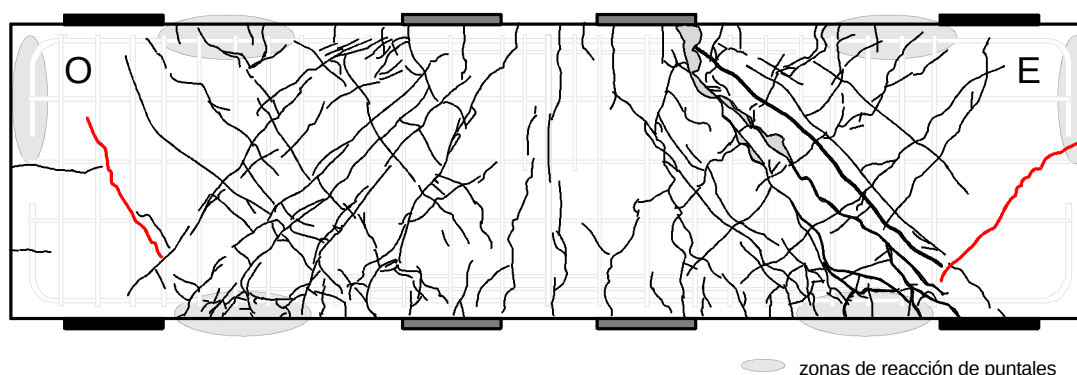
Figura 6.18 – Agrietamiento en la dirección negativa por reorientación del puntal de compresión (modelo CT)
