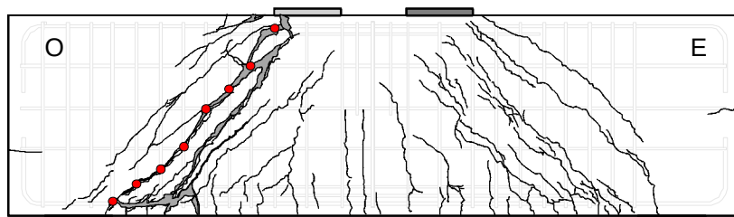
Figura 4.22 – Agrietamiento final y refuerzo transversal (modelo MT)
