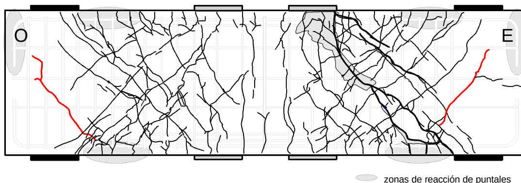
Figura 7.18 – Agrietamiento en la dirección negativa por reorientación del puntal de compresión (modelo CR)
