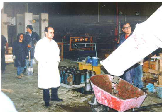
b) muestreo de los cilindros de concreto
