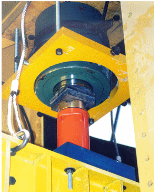
a) celda de carga para gato de 400 t
