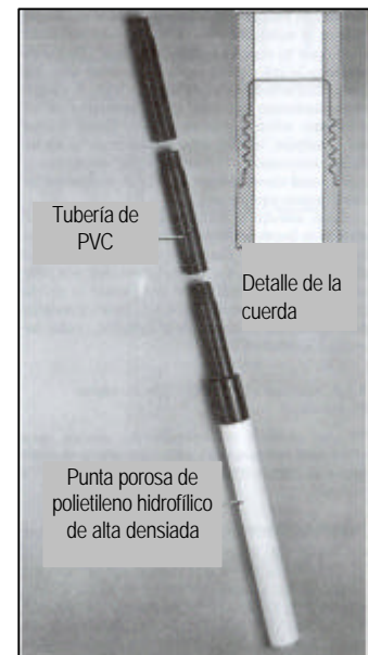
Fig. 6.18 Piezómetro de tubo abierto tipo Casagrande con punta porosa plástica (Dunncliff, 1993)
