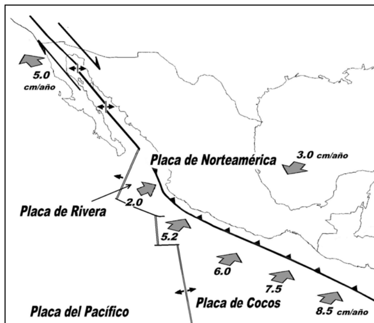
Figura 2.1 Fronteras entre placas tectónicas que definen las principales zonas sismogénicas de México. Se muestran las direcciones de desplazamiento y velocidades relativas
