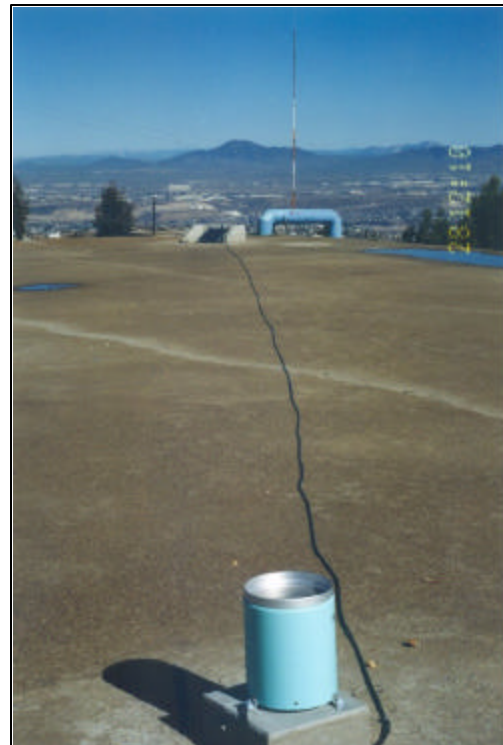
Figura 4.13 Pluviómetro y celda solar. Estación Sánchez Taboada
