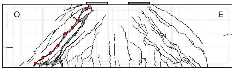
Figura 4.22 – Agrietamiento final y refuerzo transversal (modelo MT)
