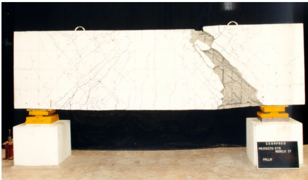
Figura 6.5 – Condición final de daño (modelo CT)
