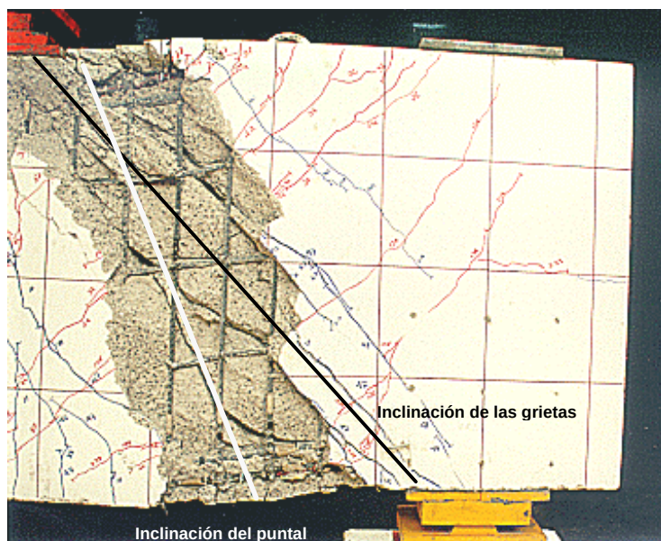
Figura 8.27 – Reorientación del puntal principal de compresión en el modelo CR
