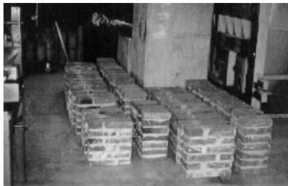
Figura A.1 - Conjunto de pilas y muretes para determinar las propiedades de la mampostería
