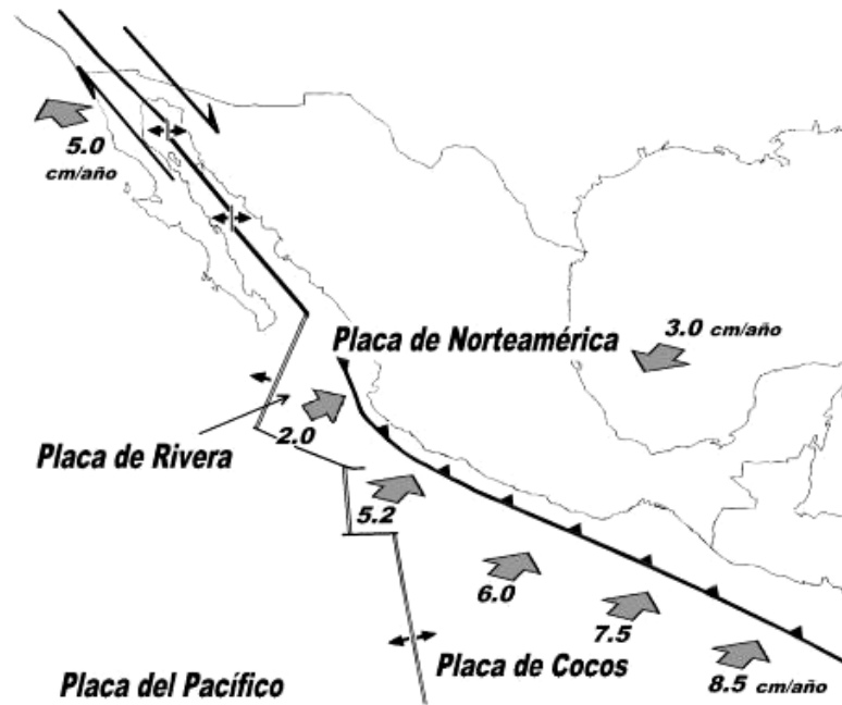
Figura 3.2 Distribución y tipo de desplazamiento de las placas tectónicas a lo largo de la costa occidental de México
