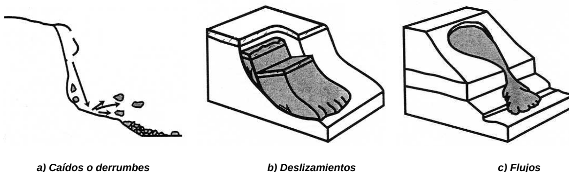
Figura 5.1 Principales tipos de deslizamientos en laderas
