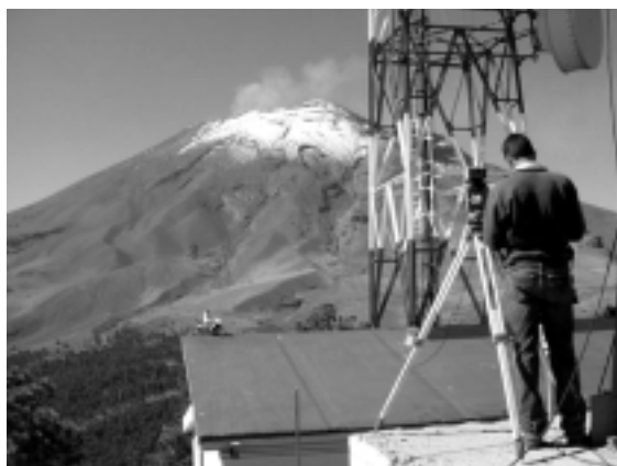
Mediciones en campo con un distanciómetro (EDM) en el volcán Popocatepetl
