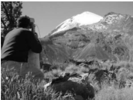
Mediciones en campo en el volcán Pico de Orizaba con un distanciómetro (EDM)
