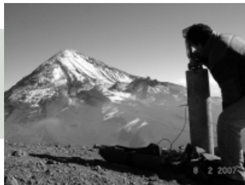
Mediciones de campo en el flanco sureste del volcán Pico de Orizaba con un distanciómetro (EDM)
