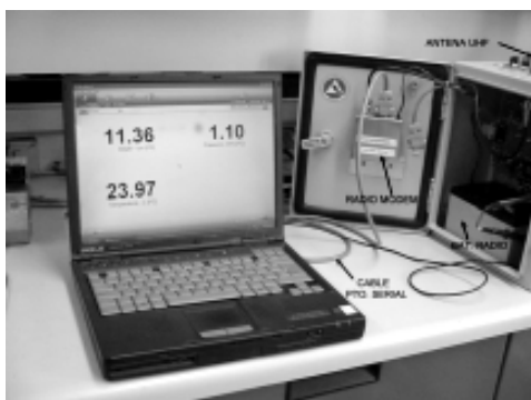
Equipo utilizado para la evaluación del sensor de nivel y su correspondiente programa de adquisición de datos.
