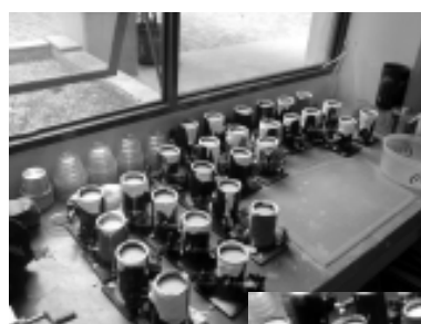
Fraguado, desmolde, saturación y ensaye a compresión simple de las muestras de \text{Ca(OH)}_2
