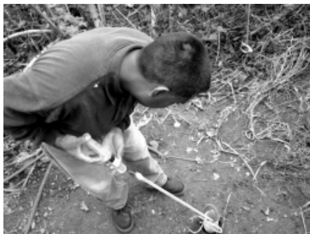
Saturación del sistema de succión en el tensiómetro colocado en el sitio B de la ladera instrumentada
