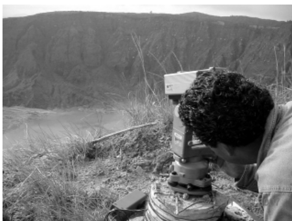
Mediciones de deformación en el cráter del volcán Chichón
